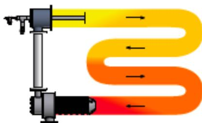
W-Strahlrohre bieten eine deutlich größere Abstrahlfläche als U-Strahlrohre, so dass diese mit höheren Brennerleistungen betrieben werden können. Für W- und U-Strahlrohre bietet IBS eine hochwirksame Emissionsminderungstechnologie, mit welcher sich sehr niedrige NOx-Emissionswerte bei gleichzeitig sehr hoher Verbrennungsluftvorwärmung erreichen lassen.
