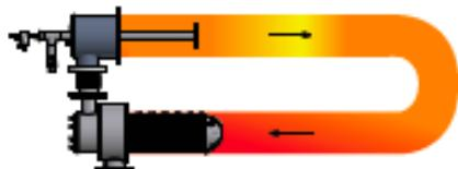
Neben Mantelstrahlrohren (siehe Seite 2) sind insbesondere U-Strahlrohre weit verbreitet. Für Neubau und Modernisierung bietet IBS Brenner-Rekuperator-Kombinationen, welche die Vorteile der hocheffizienten RECUFIRE®-Rekuperatoren auch für U-Strahlrohre nutzbar machen.
