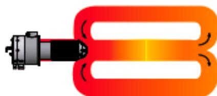
Doppel-P-Strahlrohre verfügen gegenüber U-Strahlrohren über eine deutlich größere Abstrahlfläche. RECUFIRE®-Rekuperatoren sind in Durchmesser und Leistung auf die gängigsten Strahlrohrabmessungen abgestimmt. Ob Neubau oder Modernisierung, sprechen Sie uns an!
