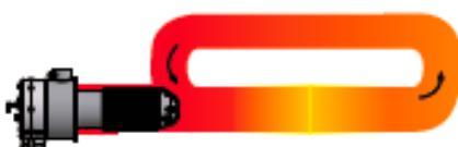
Ohne Modifikationen am Brenner lässt sich das RECUFIRE®-System an P-Strahlrohren einsetzen. Diese finden in jüngster Zeit als Alternative zu U-Strahlrohren zunehmend Verwendung.
