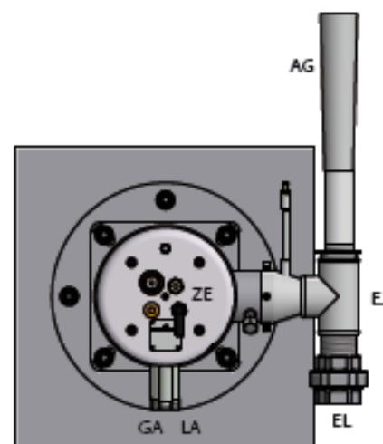
AG - Abgasstutzen mit Meßanschluß
